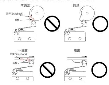
操作時避免開關壓柄承受不平均的重量。局部磨耗會導致驅動結構 損壞,耐久性降低。
